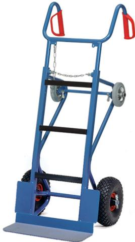
Für den Transport von schweren Geräten auf der Ebene und ganz besonders auf Treppen. Geschweißte Stahlrohrkonstruktion, pulverbeschichtet blau RAL 5007. Breite Gummiauflage, Antirutschbelag auf der Schaufel. Stützräder aus Vollgummi mit Feststeller. Griffbügel höhenverstellbar und um 180° drehbar. Dadurch kann die Griffposition für jede Transportlage optimal eingestellt werden. Spanngurt zur Ladungssicherung. Große Lufträder 300 x 100 mm, Naben mit Rollenlagerung.
