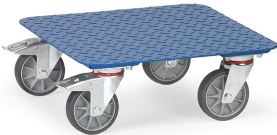
Schweißkonstruktion mit Stahl-Tränenblech-Plattform, pulverbeschichtet blau RAL 5007. 4 Lenkrollen, TPE-Bereifung, Naben mit Rillenkugellager. 2 Stück mit Feststeller, gemäß der Europäischen Norm EN 1757-3 (Sicherheit von Plattformwagen).
