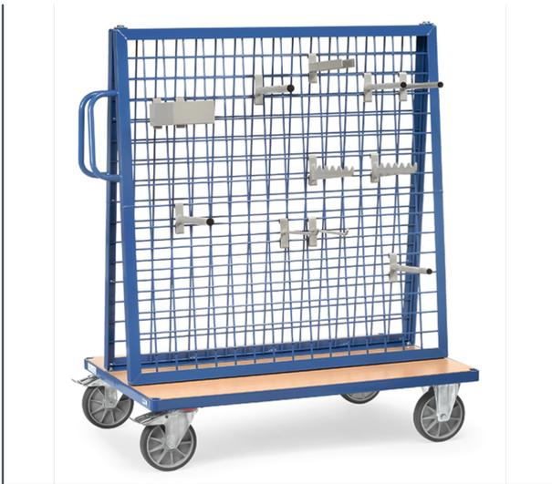
Profilstahl-Konstruktion mit eingeschweißtem Drahtgitter 75 x 75 mm, pulverbeschichtet blau RAL 5007. Boden durchgehend, Holzwerkstoffplatte, Oberfläche Buchendekor. Aufbauhöhe 1250 mm. Neigung der Gitter 11%.
