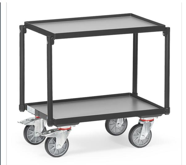
Etagen-Roller mit 2 Plattformen. Beide Rahmen mit Böden aus Holzwerkstoffplatte, Oberfläche mittelgrau, Rand 15 mm hoch. Pulverbeschichtet anthrazitgrau RAL 7016. Lichter Etagenabstand 400 mm. Tragkraft obere Ladefläche 100 kg. 4 Lenkrollen mit TPE-Bereifung, Naben mit Rillenkugellager. 2 Stück mit Feststeller. Passend für Eurokästen 600 x 400 mm. Zerlegte Anlieferung.
