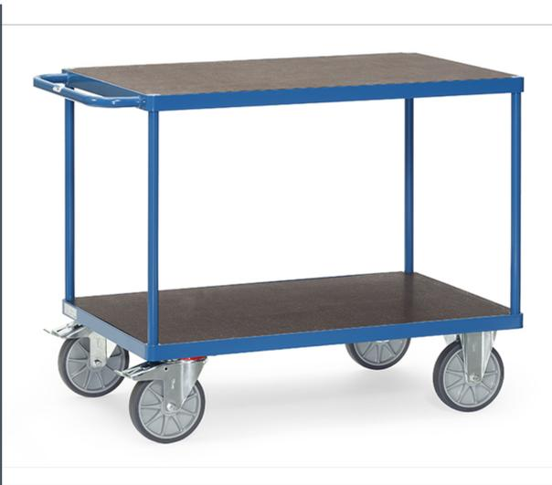
Tischwagen mit dem MultiVario Baukasten-System aus Stahlrohr und Profilstahl geschweißt, pulverbeschichtet blau RAL 5007. Dauerhaft oberflächengeschützt, schlag- und kratzfest. 2 Plattformen mit rutschsicherer Siebdruckplatte aus wasserfestem Sperrholz. Die Systemteile werden einfach eingesteckt und festgeschraubt. 2 Lenk- und 2 Bockrollen mit TPE-Bereifung und Naben mit Rillenkugellager. Feststeller an den Lenkrollen. Tragkraft obere Ladefläche 200 kg.
