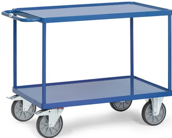
Stahlrohr und Profilstahl geschweißt, pulverbeschichtet RAL 5007. 2 Stahlblechwannen mit 10 mm hohem Rand, öldicht verschweißt, pulverbeschichtet RAL 5007. 2 Lenk- und 2 Bockrollen, TPE-Bereifung, Naben mit Rillenkugellager. Feststeller an den Lenkrollen. Tragkraft obere Ladefläche 200 kg.
