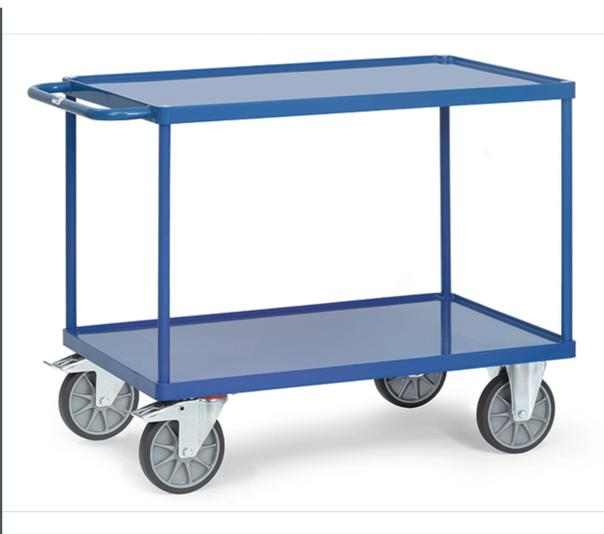
Stahlrohr und Profilstahl geschweißt, pulverbeschichtet RAL 5007. 2 Stahlblechwannen mit 10 mm hohem Rand, öldicht verschweißt, pulverbeschichtet RAL 5007. 2 Lenk- und 2 Bockrollen, TPE-Bereifung, Naben mit Rillenkugellager. Feststeller an den Lenkrollen. Tragkraft obere Ladefläche 200 kg.
