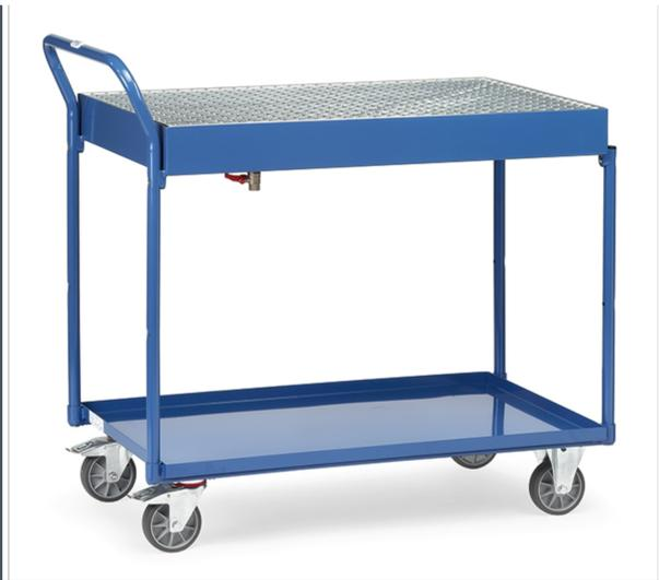
Tischwagen Stahlkonstruktion, geschweißt. Pulverbeschichtet brillantblau RAL 5007. Stahlrohrbügel und Stahlblechwannen verschraubt. Obere Stahlblechwanne 100 mm hoch, öldicht. Boden mit konischem Ablauf und Ablasshahn 1/2" zur leichten Reinigung. Gitterrost Maschenweite 31 x 31 mm, oben bündig lose eingelegt. Untere Stahlblechwanne 25 mm hoch, öldicht. 2 Lenk- und 2 Bockrollen, TPE-Bereifung, Naben mit Rillenkugellager. Feststeller an den Lenkrollen. Tragkraft obere Etage 100 kg.
