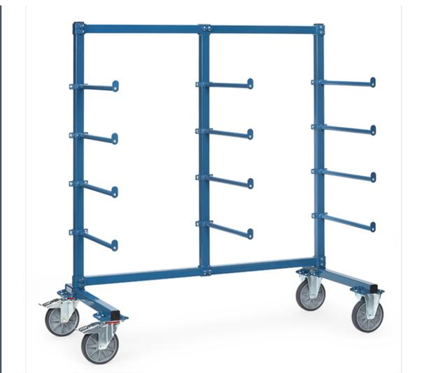
Rahmen aus stabilem Quadratrohr. Rollen-Traversen, Pfosten und Streben durch kräftige Schraubchellen verbunden. Tragarme aus Stahlrohr 27 mm Ø mit Schraubchellen. 12 Tragarme einseitig mit Abrollsicherung. Nutzlänge 600 mm, Tragkraft pro Etage 80 kg. Pulverbeschichtet blau RAL 5007. 2 Lenk- und 2 Bockrollen, TPE-Bereifung, Naben mit Rillenkugellager. Feststeller an den Lenkrollen.
