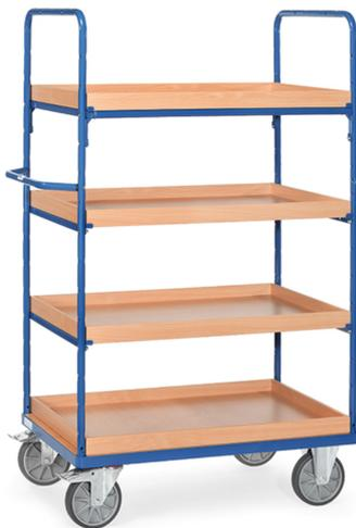
Baukasten-System: Aus Stahlrohr und Profilstahl geschweißt, pulverbeschichtet blau RAL 5007, Schraubkonstruktion. Stirnwände offen. 1 fester und 3 Einlegekästen aus Holzwerkstoffplatten, Oberfläche Buchendekor. Einlegekästen variabel einsetzbar, Teilung 100 mm. Tragkraft pro Einlegekasten 120 kg. 2 Lenk- und 2 Bockrollen, TPE-Bereifung, Naben mit Rillenkugellager. Feststeller an den Lenkrollen, gemäß der Europäischen Norm EN 1757-3 (Sicherheit von Plattformwagen).
