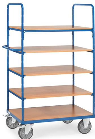
Baukasten-System: Aus Stahlrohr und Profilstahl geschweißt, pulverbeschichtet blau RAL 5007, Schraubkonstruktion. Stirnwände offen. 1 fester und 4 lose Einlegeböden aus Holzwerkstoffplatten, Oberfläche Buchendekor. Einlegeböden variabel einsetzbar, Teilung 100 mm. Tragkraft pro Einlegeboden 90 kg. 2 Lenk- und 2 Bockrollen, TPE-Bereifung, Naben mit Rillenkugellager. Feststeller an den Lenkrollen, gemäß der Europäischen Norm EN 1757-3 (Sicherheit von Plattformwagen).
