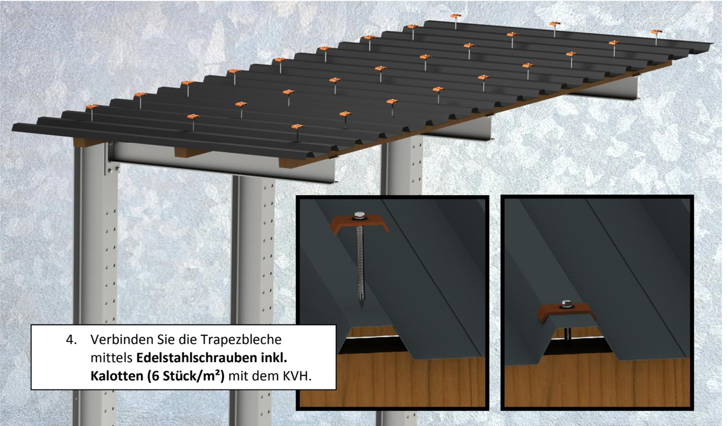
4. Verbinden Sie die Trapezbleche mittels **Edelstahlschrauben inkl. Kalotten (6 Stück/m<sup>2</sup>)** mit dem KVH.
