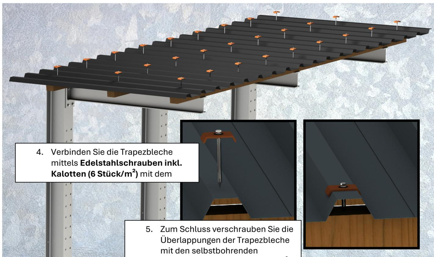
4. Verbinden Sie die Trapezbleche mittels **Edelstahlschrauben inkl. Kalotten (6 Stück/m<sup>2</sup>)** mit dem
